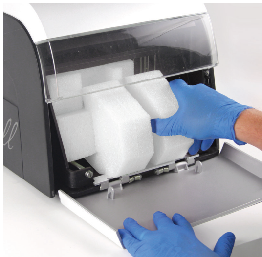
그림 7. 장비 안쪽의 스티로폼 2개 제거.
