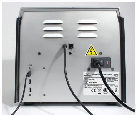
그림 3. Maxwell® CSC Instrument 뒷면. 장비의 뒷면은 On/Off 스위치, 전원 케이블 커넥터, 태블릿 PC를 연결하는 USB 통신 포트, 주변 장치(예: 바코드 리더기) 연결을 위한 별도의 USB 통신 포트 3개로 구성되어 있습니다.
