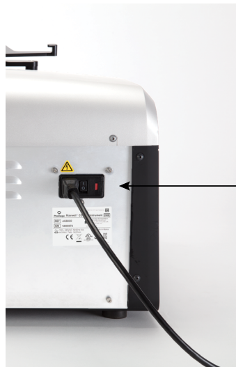
그림 12. 장비 전원 스위치와 전원 버튼. 패널 A. 장비 뒷면의 로커 On/Off 전원 스위치. 패널 B. 장비 우측의 전원 버튼.
