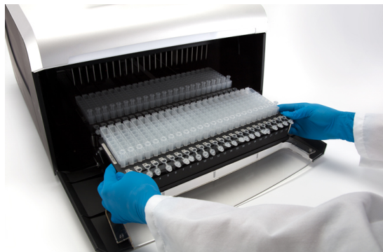
그림 39. 데크 트레이에 카트리지를 장착하고 째 소리가 나도록 째 누릅니다.
