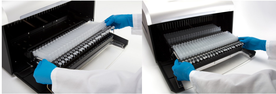
그림 41. 장비 안에 데크 트레이 장착.
