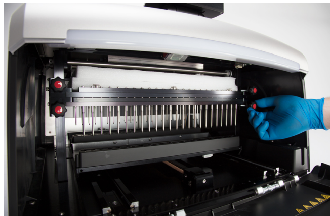
그림 62. 플라스틱 마개 넣기. 자성 막대 및 플런저 막대를 위로 올리고 자성 및 플런저 막대 양쪽에 4개의 배송 나사를 고정합니다.
