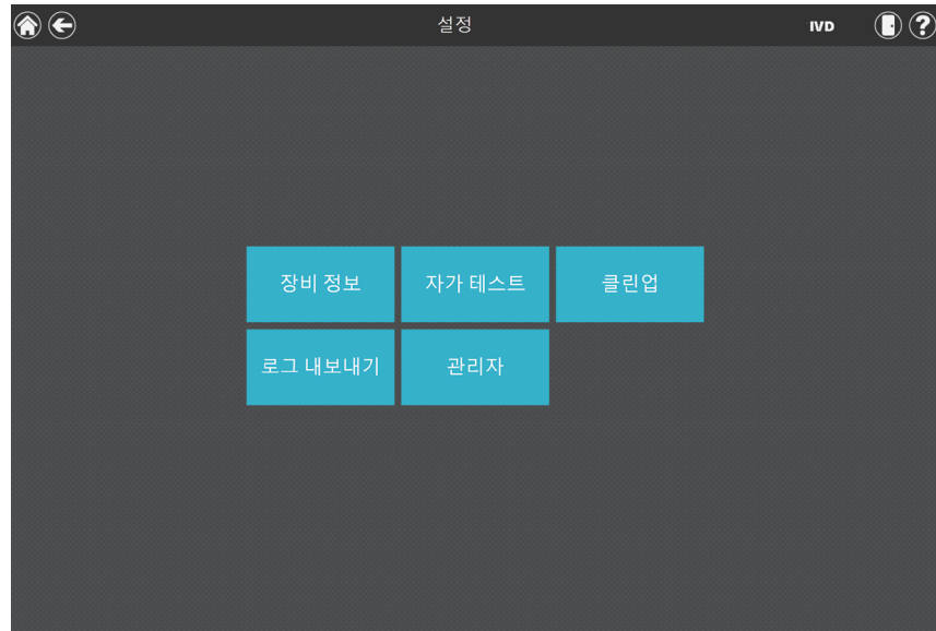
그림 16. Maxwell® CSC 48 '설정' 화면. 이 화면에서 Maxwell® CSC 48 Instrument에 대한 자가 테스트를 수행할 수 있습니다.
