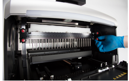
그림 7. 장비 안쪽의 스티로폼 2개 제거. 패널 A. 앞면 스티로폼 제거. 패널 B. 전면 자성과 플런저 막대 측면에서 4개의 배송 나사 제거.
