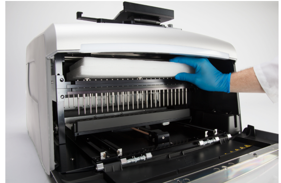
그림 8. 장비에서 상단 스티로폼 제거. 자성 및 플런저 막대를 아래로 움직여 상단 스티로폼을 제거합니다.
