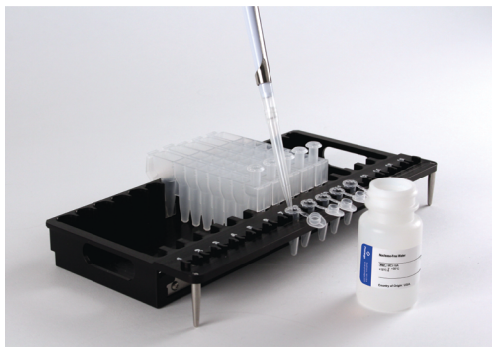
그림 1. 데크 트레이의 설치 및 구성. Nuclease-Free Water를 표시된 바와 같이 Elution Tubes에 첨가합니다. 추출 방법을 시작하기 전에 Elution Tubes를 엽니다.
