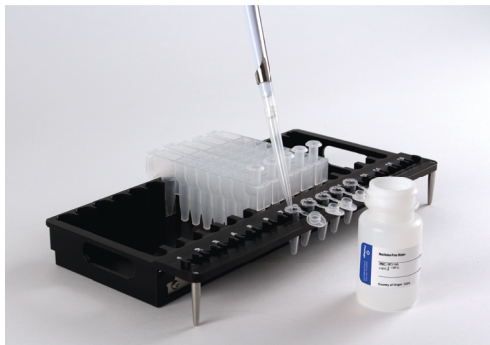
그림 7. 데크 트레이의 설치 및 구성. Nuclease-Free Water를 표시된 바와 같이 Elution Tubes에 첨가합니다. 추출 방법을 시작하기 전에 Elution Tubes를 엽니다.
